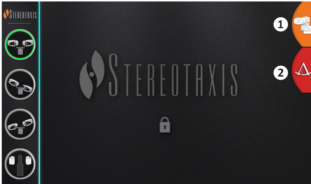
Kuva 11. UTSC-paneeli: Vasemmalla potilastason viereisen yleisohjaimen painikkeet; oikealla (1) suurenee ja näyttää 4 painiketta lisää seuraavalla näyttöruudulla ( Kuva 12 ); (2) yhdistää Navigant -näyttöön.
