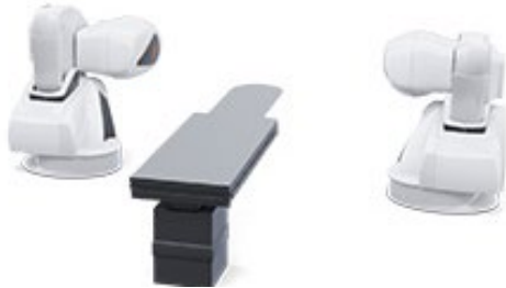
Kuva 15. Genesis RMN -järjestelmän magneetit kiinnitettyssä asennossa.
