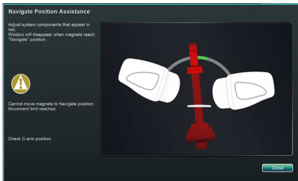
Obrázok 18. Hlásenie o riziku kolízie s C-ramenom
