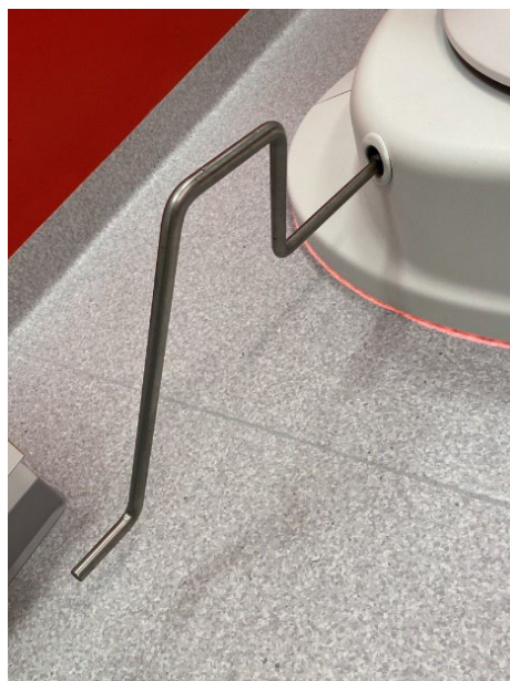
Figure 23. Barre de manivelle insérée dans le port d'accès de la manivelle
