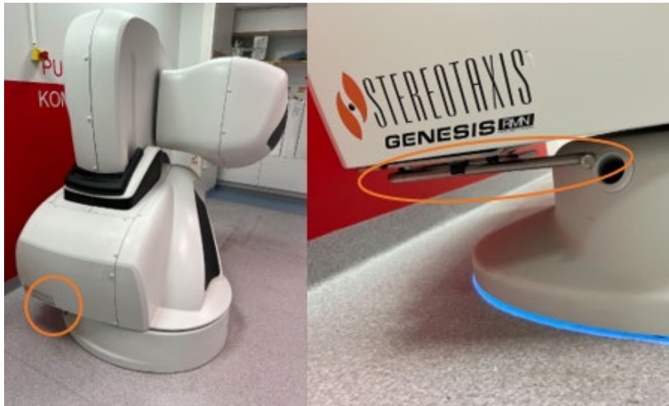
Figura 22. Localização da barra da manivela manual
