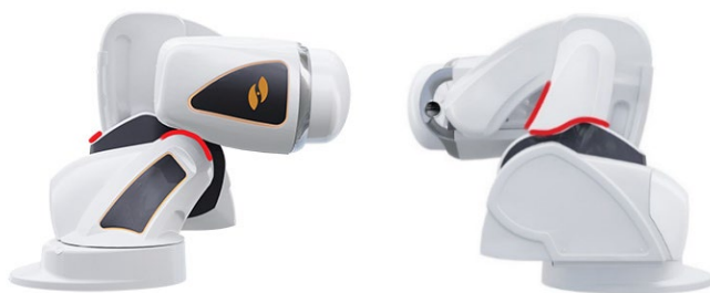
Figura 10. Áreas de perigo de aperto (assinaladas a vermelho)
