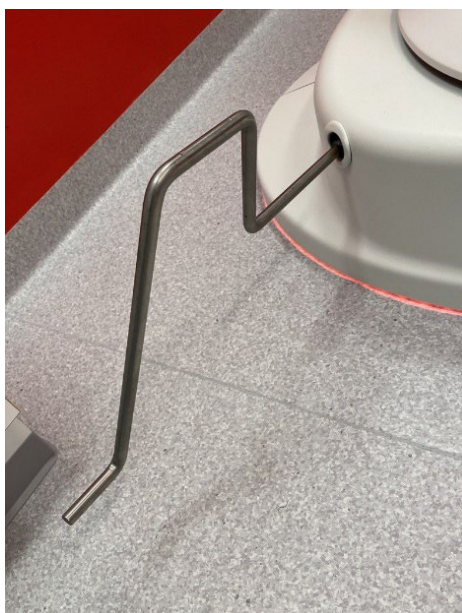
Obrázok 23. Tyč ručnej kľuky zavedená do prístupového portu
