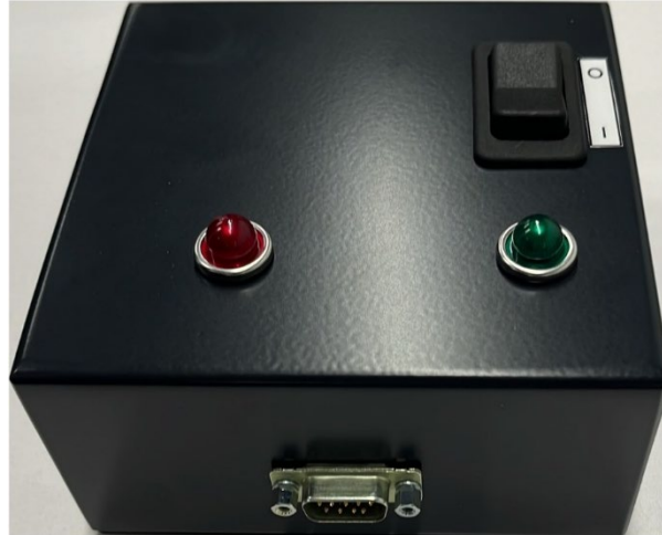
Figura 10. Scatola di alimentazione nella sala di controllo
