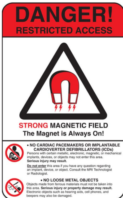
Figura 1. Cartello di sicurezza magnetica con elenco dei rischi per la salute e la sicurezza associati ai magneti
