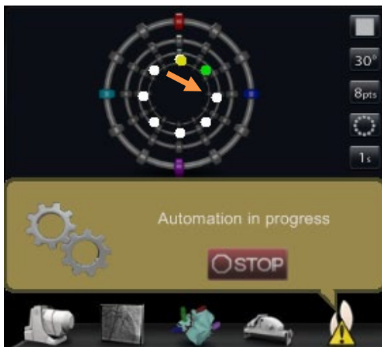
Kuva 69: Bullseye-kohdistus ympyrämalli näkyvässä automaatioviesti ja PYSÄYTÄ (STOP) -painike
