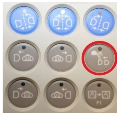
Kuva 14b: Kiinnityspainike on potilastason viereisessä ohjaimessa äärioikealla toisessa rivissä (esitettyinä Siemensin värit)
