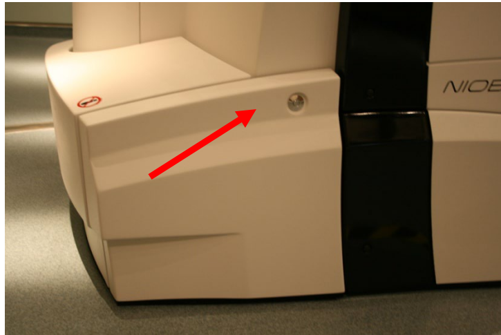
Kuva 196: Niobe ES -suojaus hätätilanteessa manuaalista runkojen liikuttamista varten
