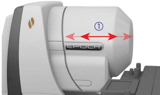
Kuva 19: Niobe ES -magneettisuoja siirtyä eteen- ja pois päin potilastasosta (katso numeroidut viitteet oheisesta oppaasta)
