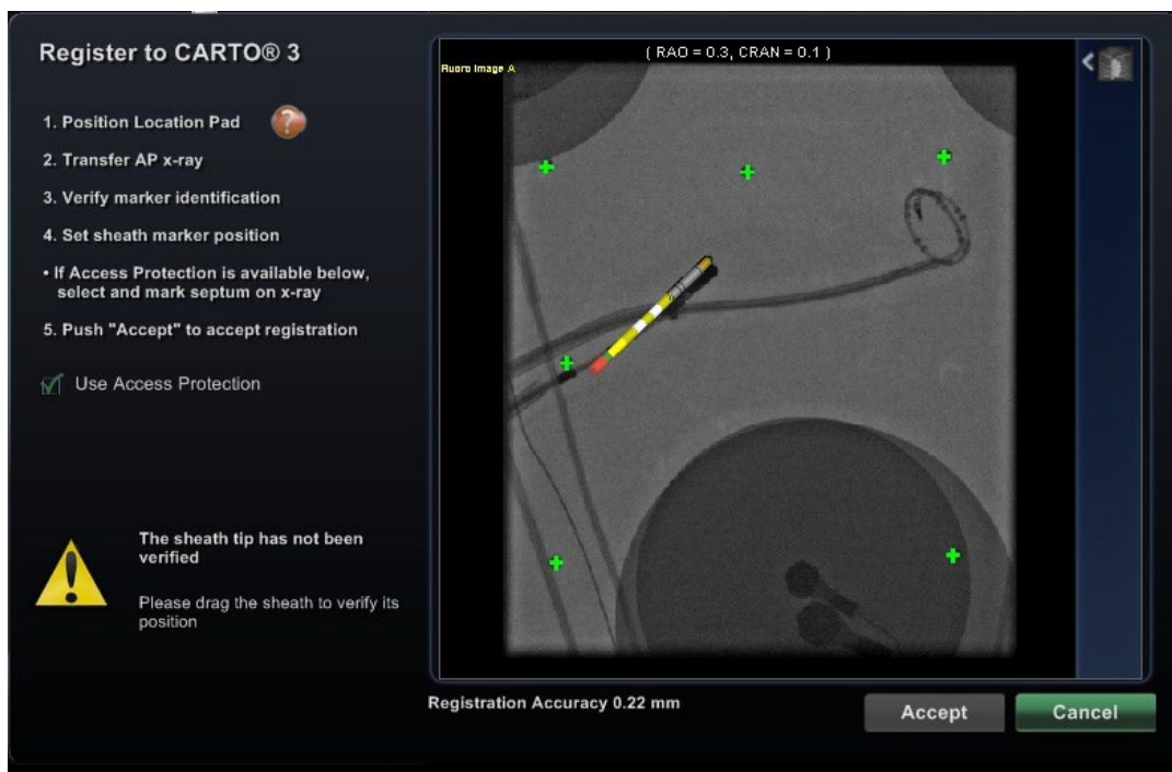
Kuva 113: Käytön suojaus – holkin kärjen varmistus
