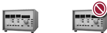
Figure 160. Icône d'état historique d'ablation du générateur indiquant à gauche une connexion et à droite une absence de connexion
