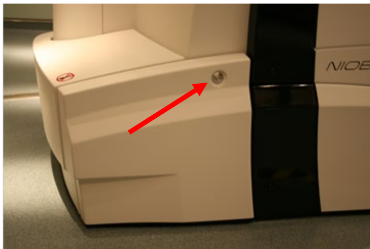
Figure 217. Capot Niobe ES pour mouvement manuel des têtes en urgence
