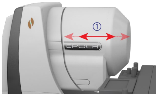
Figure 19. Le capot de l'aimant Niobe ES s'approche et s'éloigne de la table d'examen (voir la légende ci-dessous pour les références numérotées)
