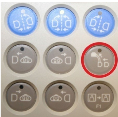
Figure 14b. Le bouton de rangement se trouve tout à droite de la deuxième rangée sur le dispositif de commande de la table (couleurs de Siemens présentées)
