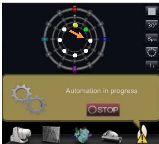
69 pav. Bullseye taikinio nustatymo apskritiminis išdėstymas su pranešimu apie automatizavimą ir mygtuku STOP (stabdyti)
