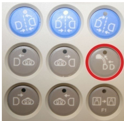
14b pav. Kraštinės padėties mygtukas yra stalo šoninio valdiklio antros eilės dešinėje (rodomos „Siemens“ spalvos)
