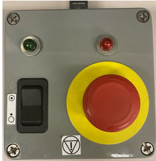
12. Remote System Power Box: Genesis a Siemensszel
