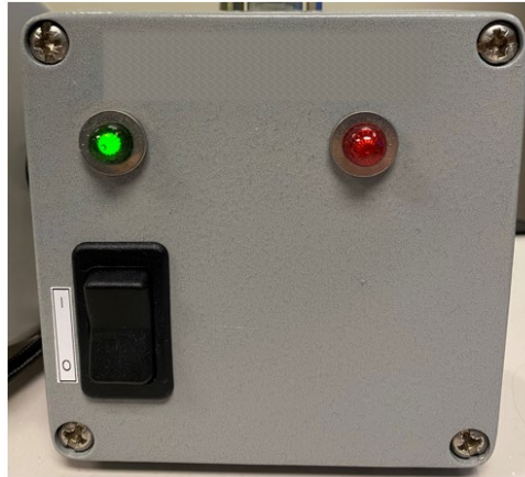
Obrázok 10. Napájací modul vzdialeného systému
