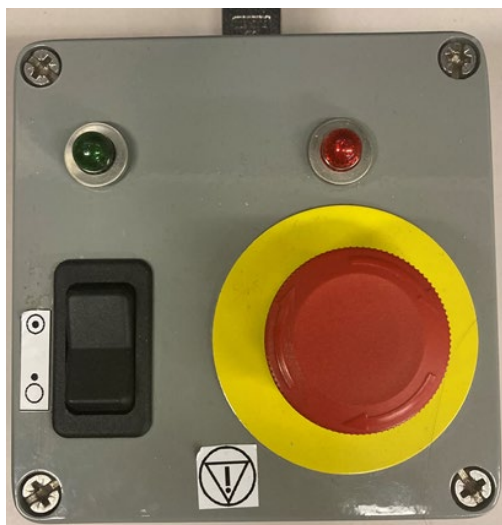
Obrázok 12. Napájací modul vzdialeného systému: systém Genesis so systémom Siemens
