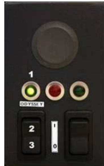
Kuva 9. Vision -etävirtarasia magneetittomiin laboratorioihin
