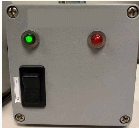
Figura 10. Box di Alimentazione Remota del Sistema
