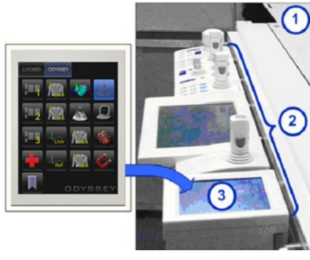
Figura 2. Controller sul binario per gli accessori del lettino del paziente
