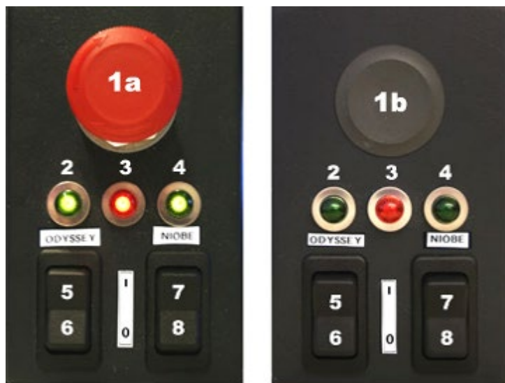
8 pav. „Vision“ nuotolinė maitinimo dėžutė „Siemens/Neusoft“ laboratorijoms (kairėje) ir „Philips“ laboratorijoms (dešinėje)
