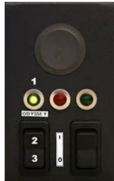
Figura 17. Caixa de alimentação remota Vision para laboratórios não magnéticos
