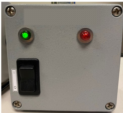
Figura 10. Caixa de alimentação do sistema remoto
