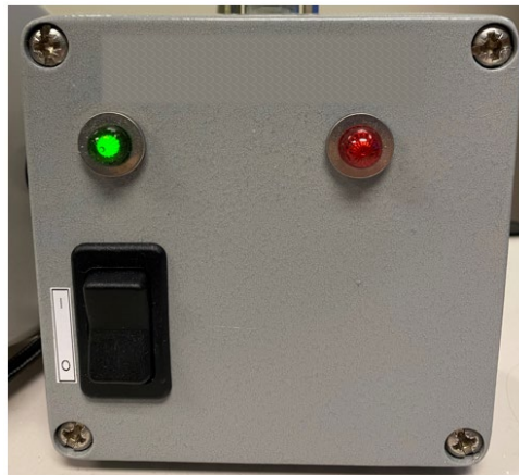
Figura 10. Caixa de alimentação do sistema remoto
