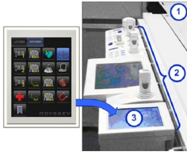
Obrázok 2. Ovládací panel na stôl na montážnom držiaku na stole pre pacienta
